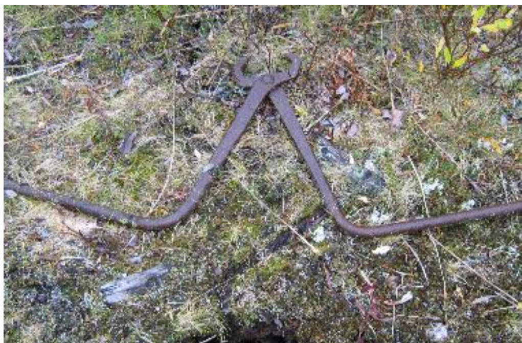
Fot. 70. „Szczypce” służące do przenoszenia szyn
